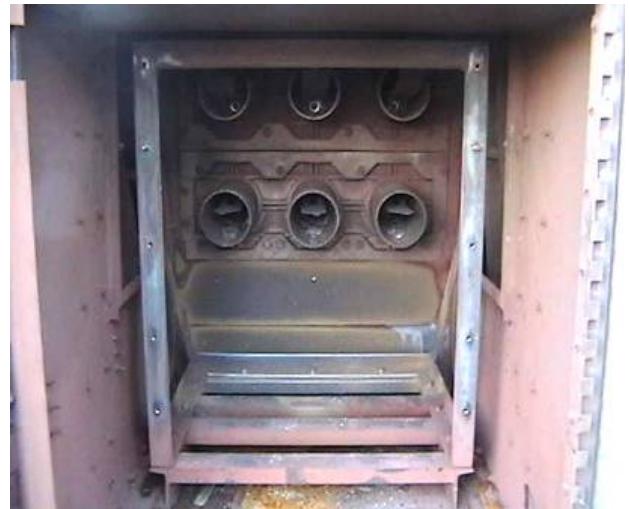
图3. 测试结果用500ms燃弧时间
