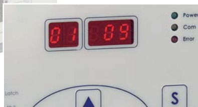
Ein detaillierter Adresse-Code mit Angaben zum Fehlerort wird im Störlichtbogenfall in der Zentraleinheit angezeigt.
